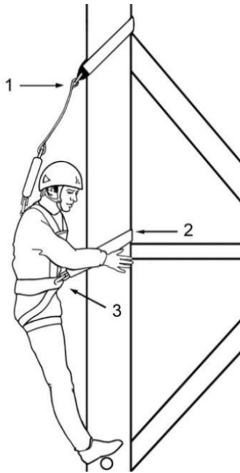
Рис.Е.6 — Пример уса для рабочего позиционирования используемого для частичной поддержки (как столбовой строп).
